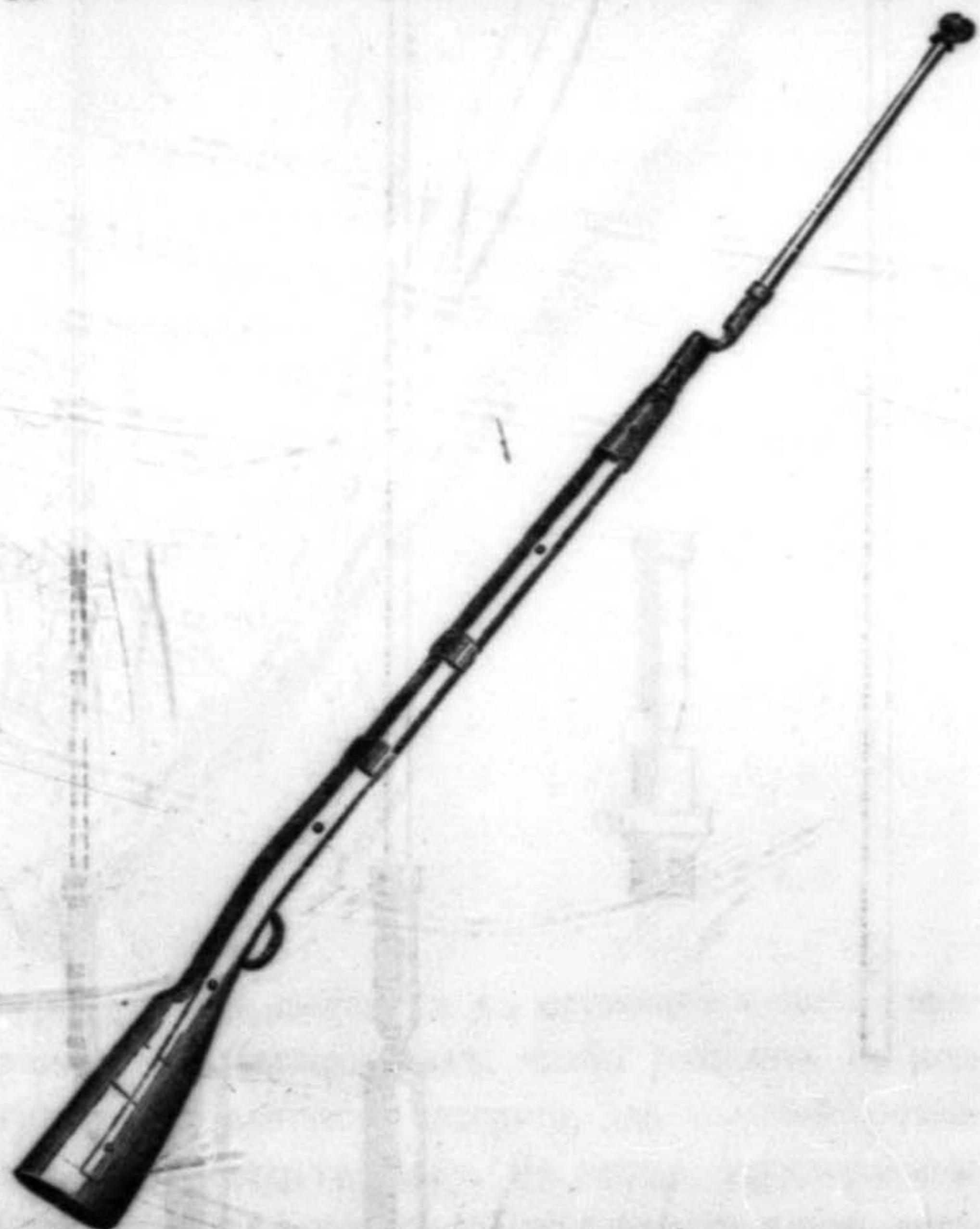
Чтобы придать болванкѣ вѣсъ ружья, съ двухъ сторонъ врѣзываются двѣ желѣзныя полосы, которыя прикрѣпляются къ древку тремя желѣзовыми гайками; на концѣ болванки насаживается штыкъ, приспособленный какъ выше сказано; за неимѣніемъ штыковъ можно употребить эспадронный клинокъ, прикрѣпленный къ болванкѣ (\*).
