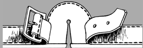
Пряжка для регулирования размера кивера в застегнутом и расстегнутом состояниях
