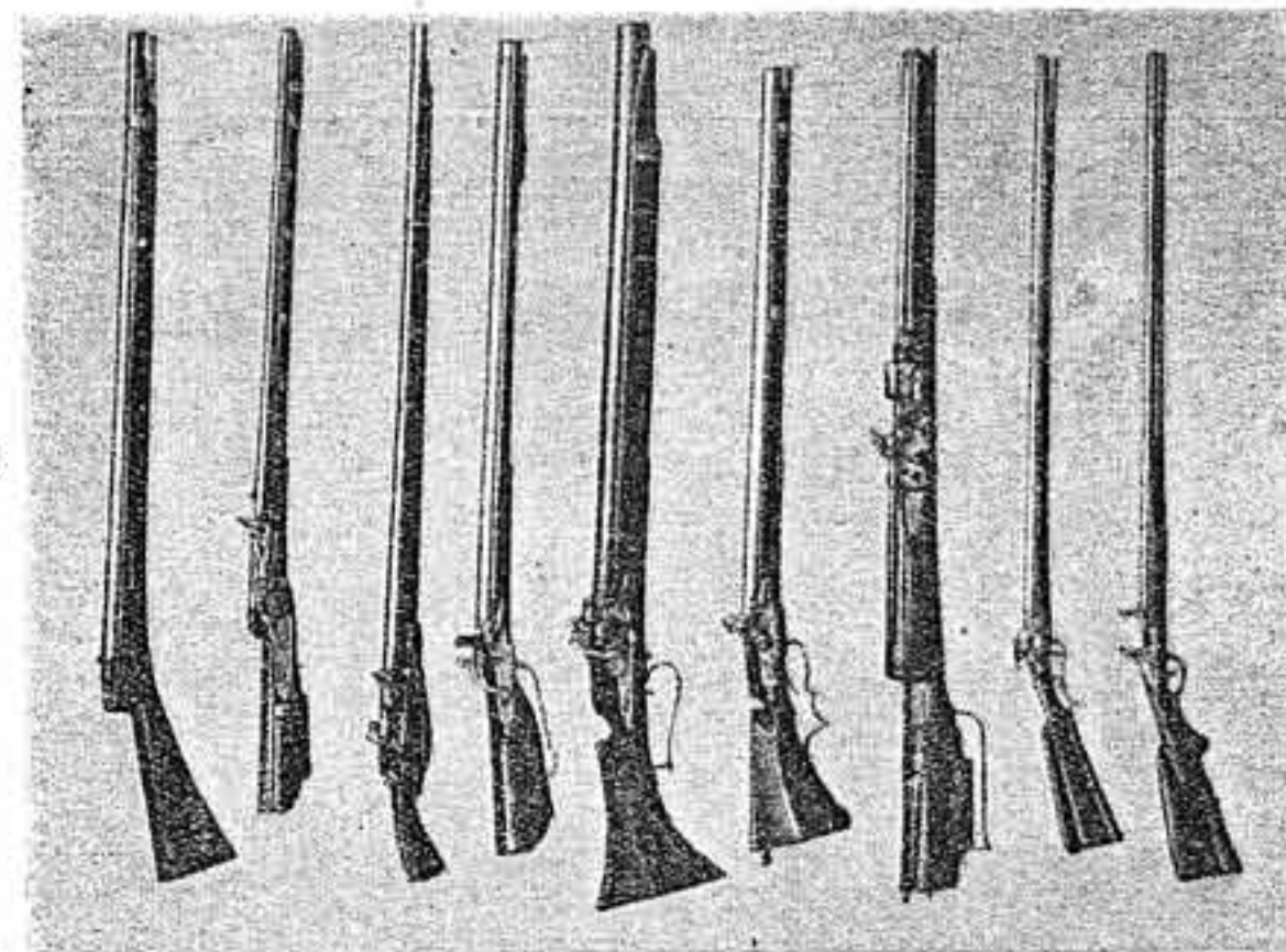
Огнестрельное оружие XVII и начала XVIII в., по порядку слева направо: турецкое фитильное ружье начала XVII в., охотничья аркебуза с колесным замком, пицаль XVII в., нарезное ружье немецкой работы XVII в., мушкет немецкой работы XVII в., мушкет XVIII в., магазинное ружье на 12 зарядов XVII—XVIII вв., ружье испанской работы XVII—XVIII вв., итальянское ружье начала XVIII в.
