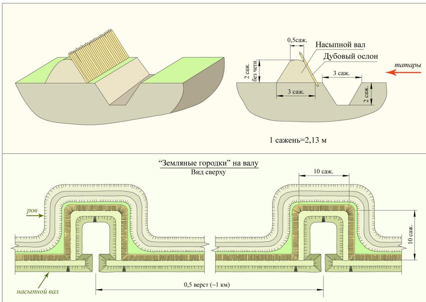
Чертеж защитного земляного вала XVII в.
