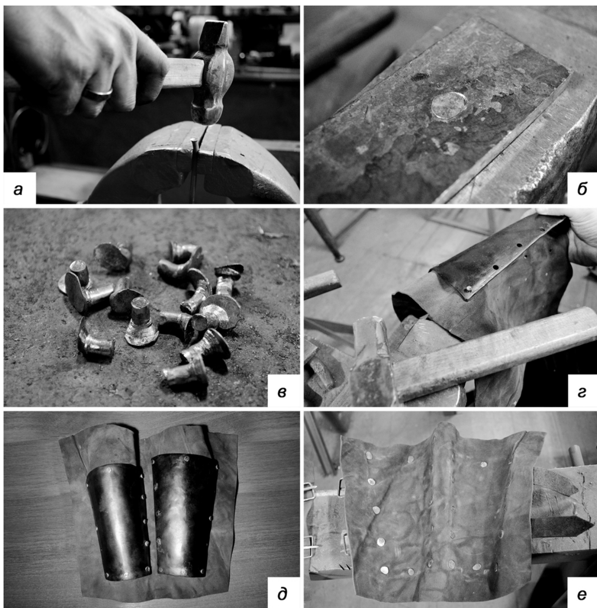
Рис. 4. Изготовление и монтаж клёпок:
