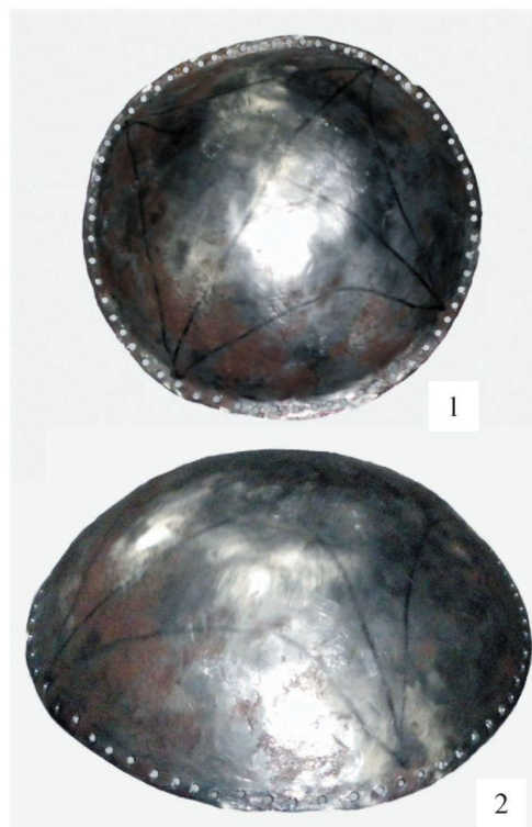
Рис. 4. Изготовление «череп»: 1 – заготовка «череп» после разметки и сверловки; 2 – заготовка «череп» после выравнивания края
