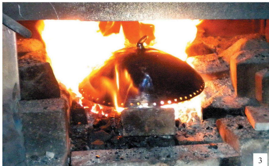
Рис 5. Изготовление кольца и воронение «черепа»:
