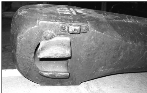
Рис. 4. Ствол бухарской казнозарядной пушки (инв. № 010/132). Вид слева, видна конструкция клина замка орудия
