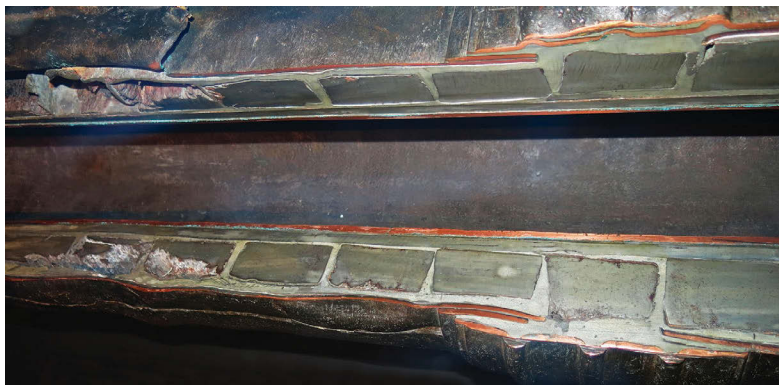
Ил. 7а и 7б. Продольный вырез на композитной пушке с «Батавии» (Western Australian Shipwrecks Museum, Фримантл, Австралия)
