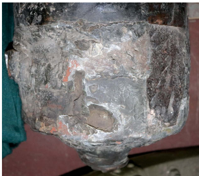
Ил. 5. Пушка МЧА 9/48. Повреждения корпуса: видны следы крепления железной основы цапф
