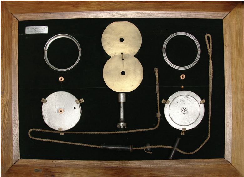
Ил. 13. Обтюратор системы Бродвеля, позволивший решить проблему надежного запирания затвора орудия во время выстрела, предотвращения прорыва пороховых газов
