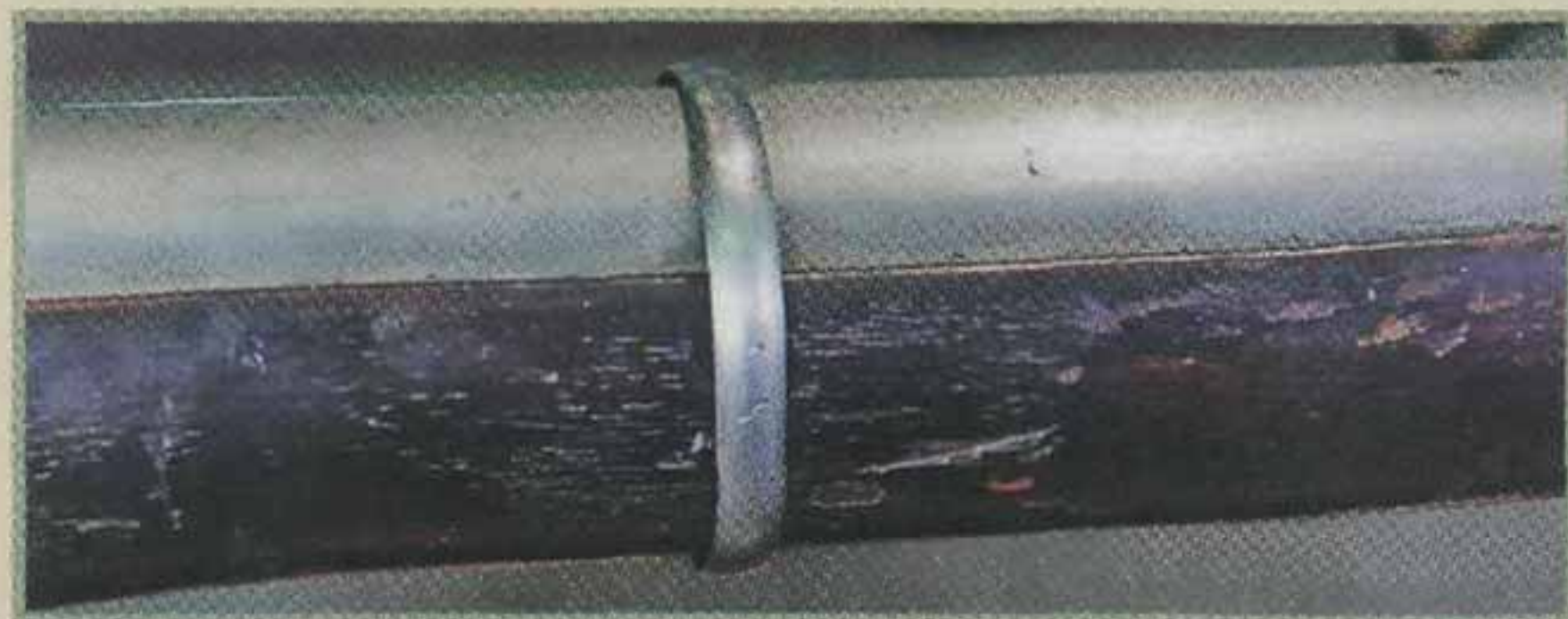
Кольца прибора казачьих ружей сравнительно узкие, держатся исключительно за счёт трения
