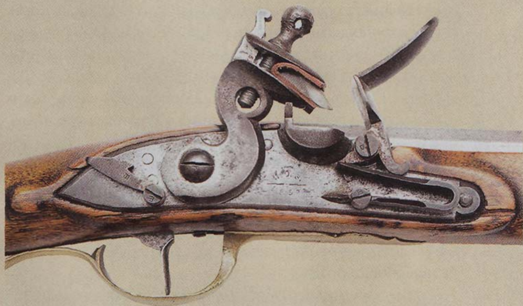
Замок мушкетона классический ударно-кремневый с предохранительной собачкой, характерной для XVIII в.
