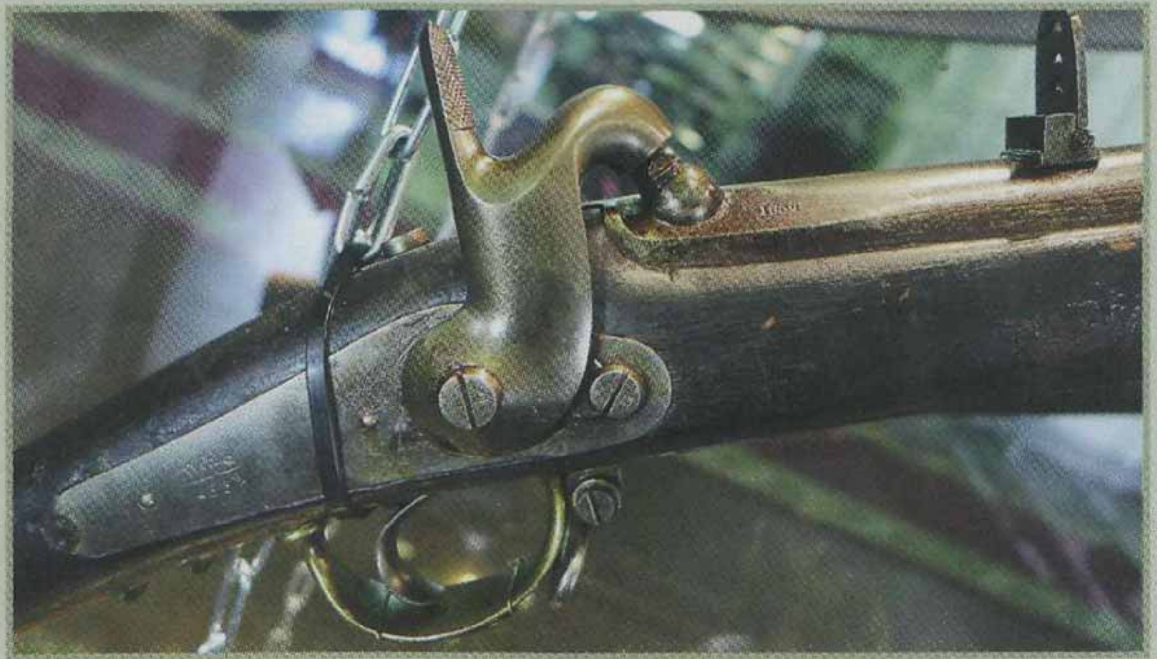
Замок штуцера системы Гартунга, переделанного из сапёрного ружья обр. 1847 г.
