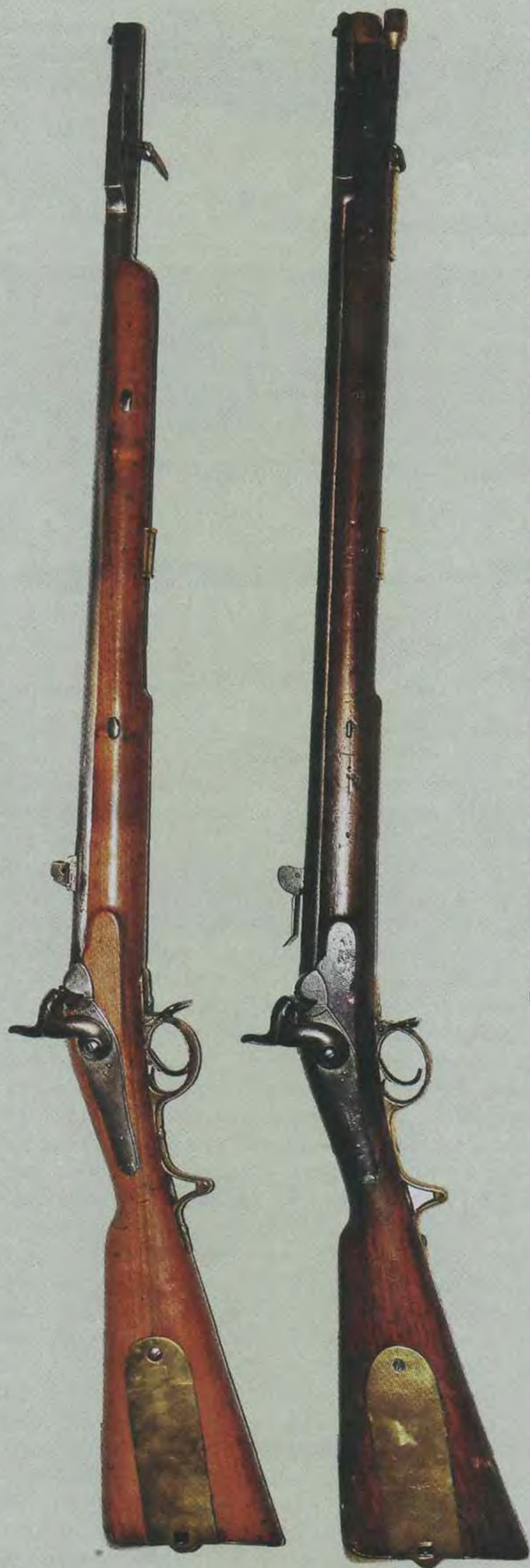
Литтихские штуцера: слева — поздний тип производства Фалиса и Трапмана (колодка прицела модификации Юнга), справа — производство Малебра с прицелом гессенского типа
