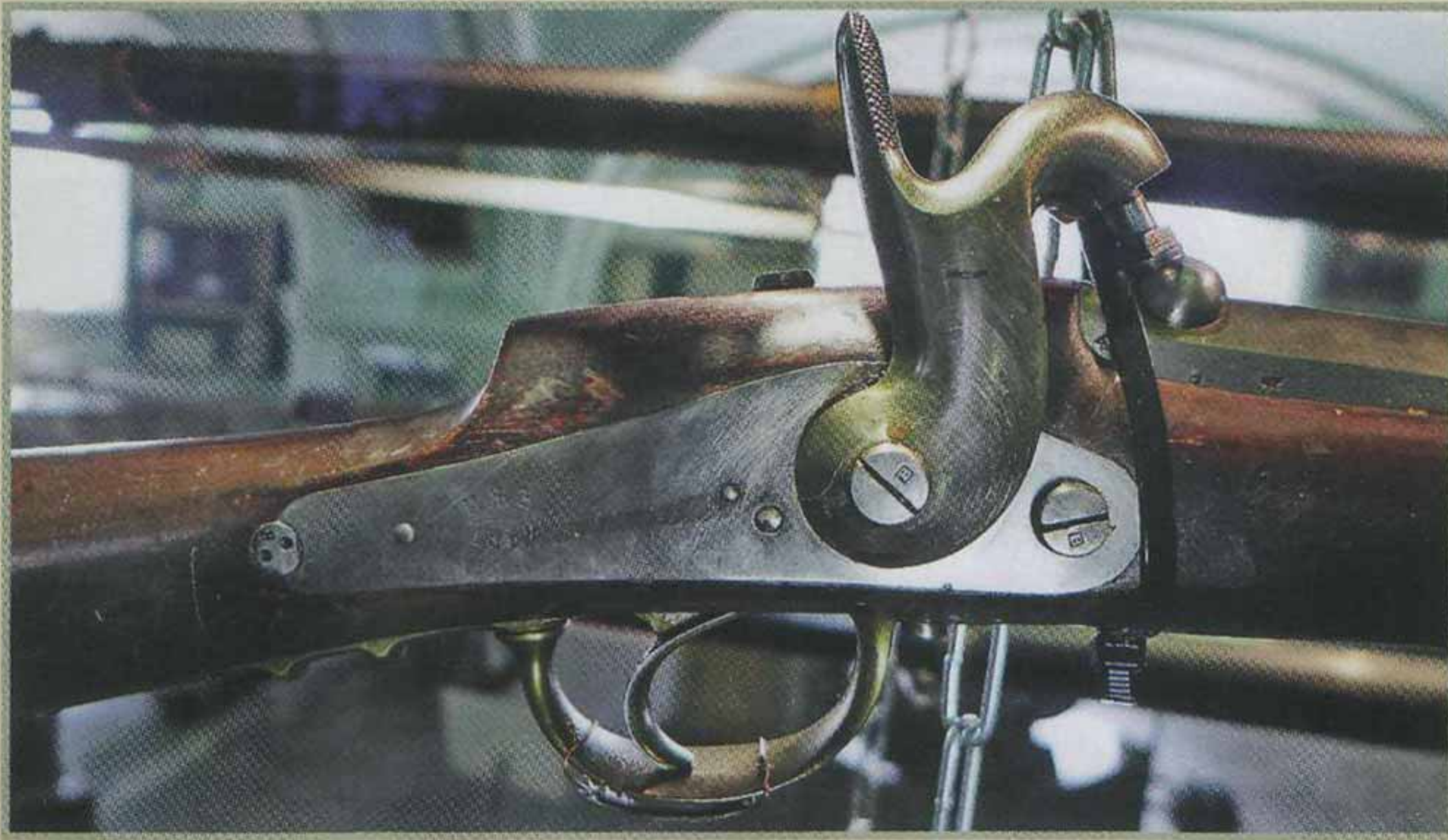
Новый тип замка (обратный «в шейку») появился на ружьях обр. 1846 г.
