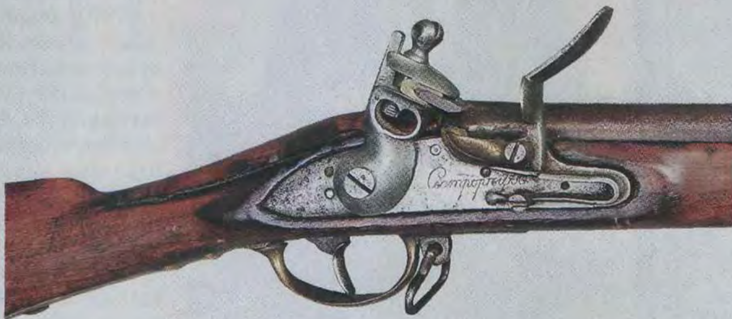
Прицелы в виде возвышения — холки с прорезью появились на пехотных ружьях в 1826 г.
