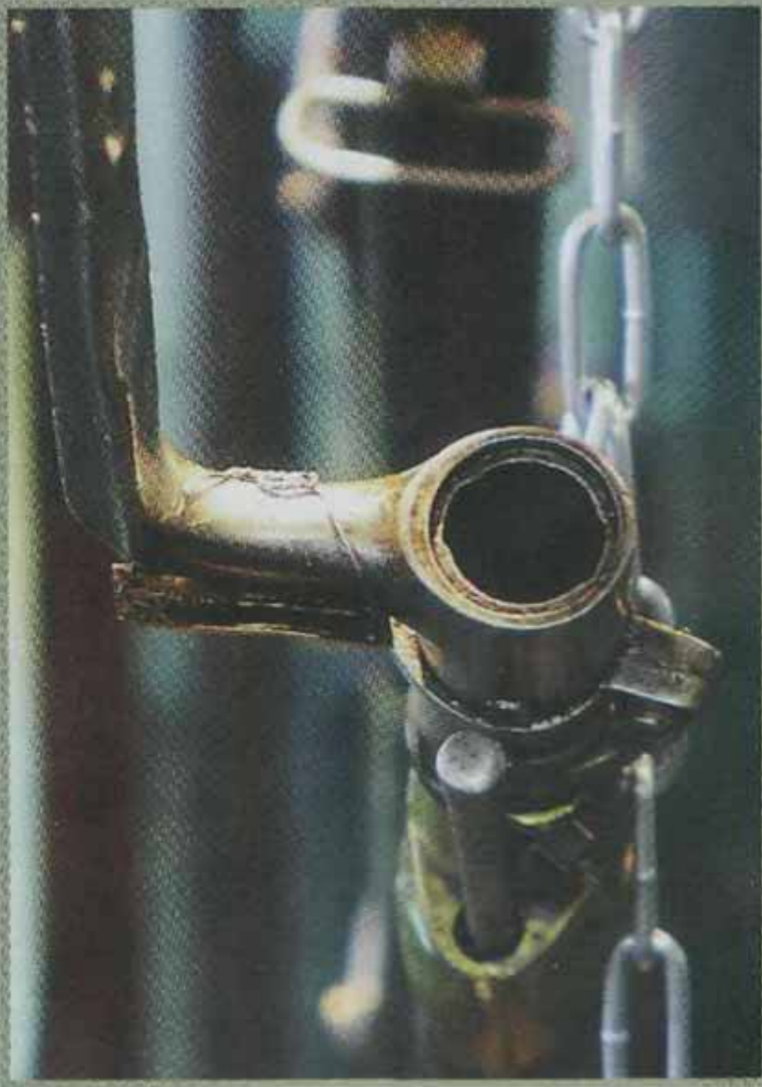
Дульный срез штуцера с выходами двух нарезов
