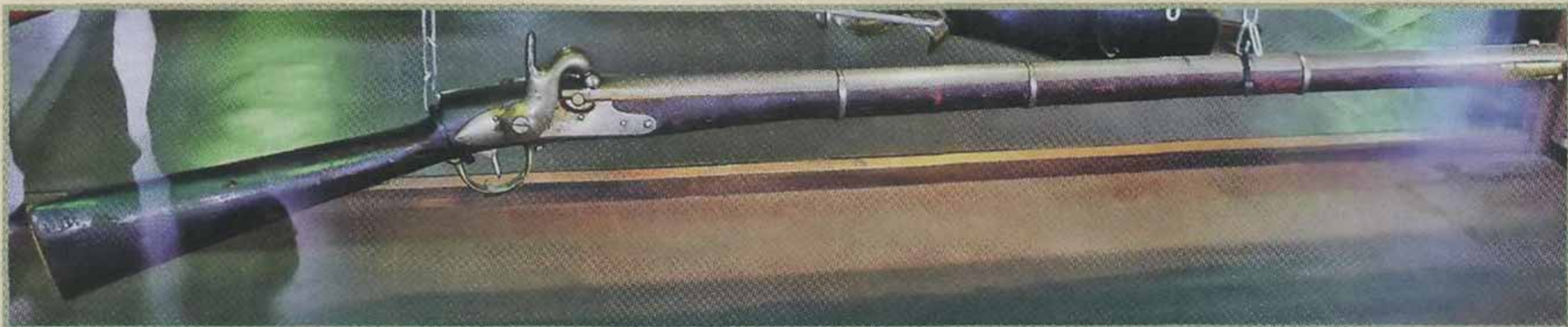
Казачье переделочное из ударно-кремневого образца 1832 г. ружьё
