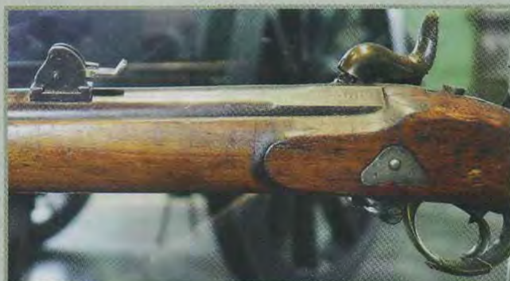
Дальнейшее развитие стрелковой винтовки обр. 1856 г. — пехотная винтовка обр. 1858 г., отличающаяся от своего прототипа только прицелом
