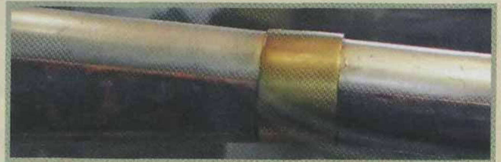
Заднее ложевое кольцо карабина совмещалось с передним окончанием погона
