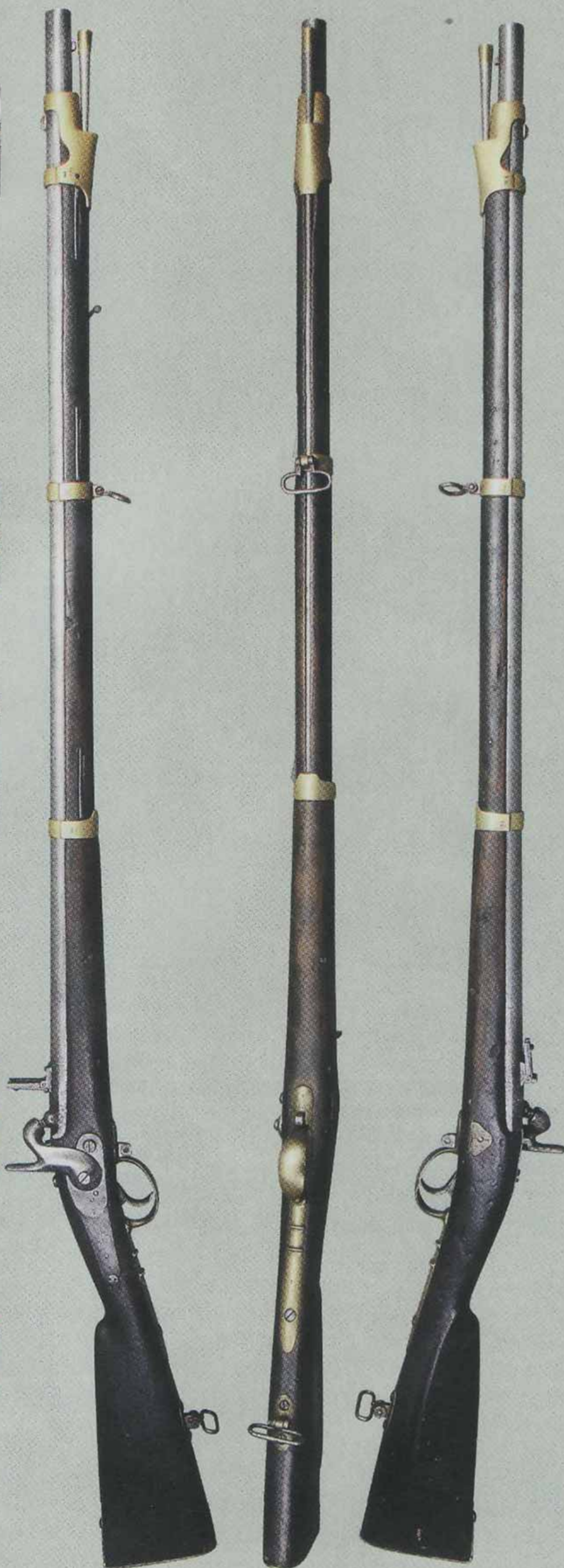
Драгунское 7-линейное ружьё обр. 1854 г. На ружьё установлен прицел несоответствующего типа. Предположительно замена прицела была произведена после того, как ружьё попало в руки противника
