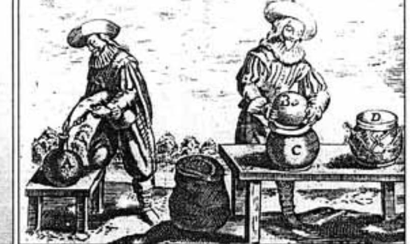
Процесс снаряжения мортирных бомб и изготовления зажигательных снарядов
