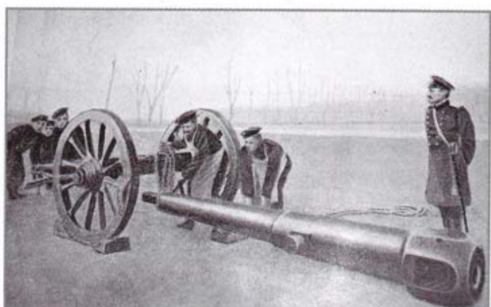
Подъём 24-фунтового орудия с земли и наложение его на подкладки с помощью осадного передка
