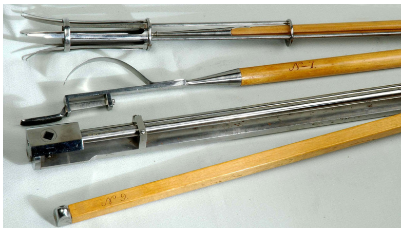
Ил. 1. Комплект инструментов «Прибор для заделывания раковин в каналах орудий». Сверху вниз: щуп или «трещотка» (Т II-117/5), напильник (Т II-117/7), прибор для заделывания раковин (Т II-117/1), шест с воском на конце (Т II-117/9). Действующая модель. Масштаб 1 : 2–3
