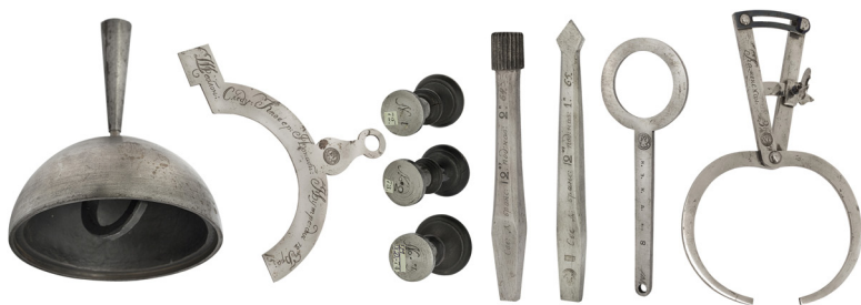
Ил. 6. Слева направо: модель для формовки брендсугелей 12-фунтового калибра (ТХВ-29/3-2); шаблон, применяемый при набивке сердечников при производстве брендсугелей 12 фунтового калибра (ТХВ-29/15); модели для формовки картечной дроби № 1–3; сверло для сверления пробок у брендсугелей 12-фунтового калибра на втором этапе (ТХВ-29/65); сверло для сверления пробок у брендсугелей 12-фунтового калибра на начальном этапе (ТХВ-29/65); кружало для калибрования картечной дроби № 8 (ТХВ-100); кронциркуль для измерения толщины стенок у гранат \frac{1}{4} -пудового и брендсугелей 12-фунтового калибра (ТХВ-68)
