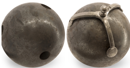
Ил. 7. Brand-сугель (ТХВ-31) с инструментом для определения мест размещения пробок у brand-сугелей 12-фунтового калибра (ТХВ 29/59)
