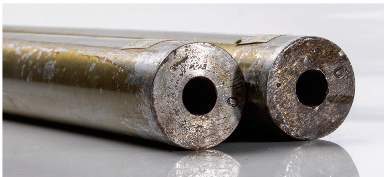
Ил. 4. Два ствола из литой обуховской стали для винтовки Бердана № 2. Златоустовская Князе-Михайловская сталелитейная фабрика. 1873 г. Горный музей
