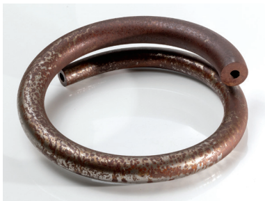
Ил. 3. Ружейный ствол из литой обуховской стали для винтовки Бердана, согнутый в кольцо в холодном состоянии. Златоустовская Князе-Михайловская сталелитейная фабрика. 1868–1873 гг. Горный музей
