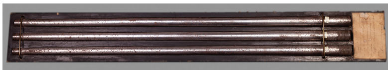
Ил. 2. Стволы из литой обуховской стали для винтовки 4,2 лин. калибра, испытанные пороховой пробой. Златоустовская Князе-Михайловская сталелитейная фабрика. 1870 г. Горный музей
