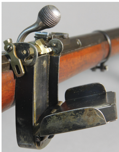
Ил. 9–10. Чертеж ускорителя заряжания конструкции Лутковского патента №4198 от 31 августа 1883 г. и вид с тыльной стороны на ускоритель заряжания, ВИМАИВиВС ОФФ 5-301
