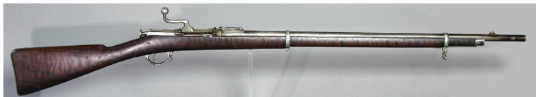
Ил. 14а. 4,2-лин. винтовка обр. 1870 г., переделанная под установку ускорителя заряжания конструкции Малкова-Паскиных, И.Т.О.З., общий вид справа, ВИМАИВиВС ООФ 5-306
