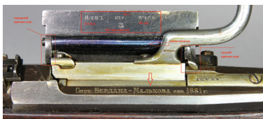
Ил. 13. Приёмник ускорителя заряжания конструкции Малкова-Паскиных, вид слева; обозначения и клейма «И.Т.О.З.», «81 г.», «№ 128», «СМ под короной» (клеймо С. И. Мосина – винтовка переделывалась под его наблюдением в инструментальной мастерской И.Т.О.З., которую он возглавлял); ниже нанесено наименование винтовки с ошибкой в фамилии – подобные ошибочные (либо некорректные) наименования наносились в музее в первой половине XX века, ВИМАИВиВС ООФ 5-305
