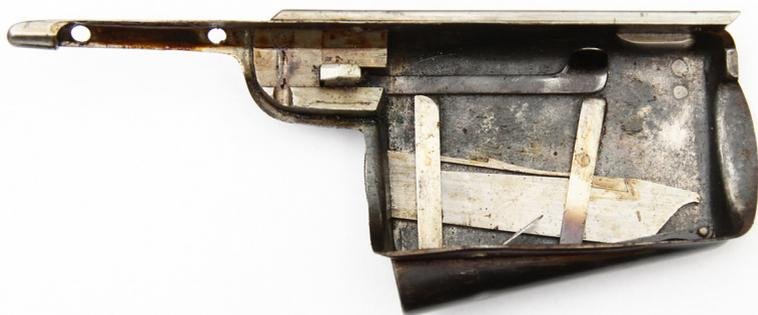
**Ил. 5. Внутренний вид магазина емкостью четыре патрона; поджимная пружина в отключенном состоянии**
