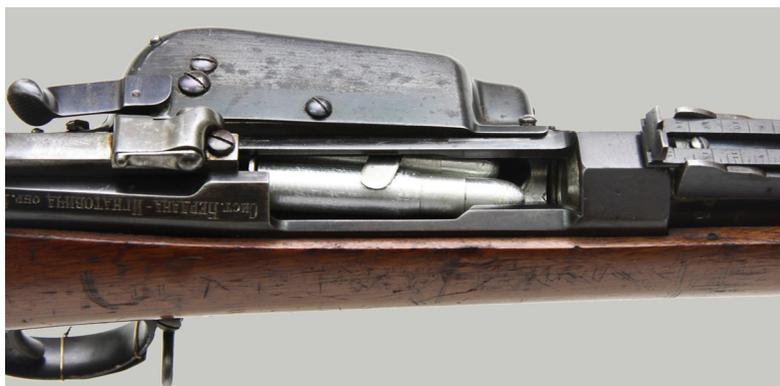
**Ил. 10. Вид внутренней части ствольной коробки и наполненного патронами магазина; на снимке видна ложка, удерживающая патроны от выпадения при стрельбе лежа на спине или на боку**
