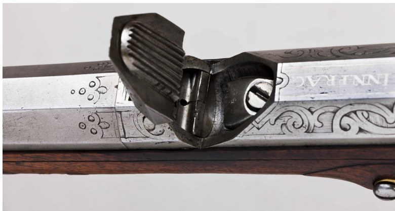
Ил. 6. Замок ружья, инв. № ГДМ-717-IX. Крышка с огнивом поднята, видна заправочная полка с отверстием и курок
