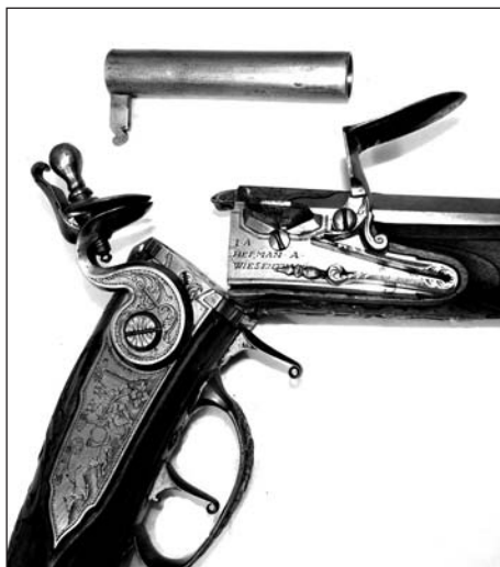
Рис. 7. Замок и сменный казенник ружья № ГДМ-578-IX
