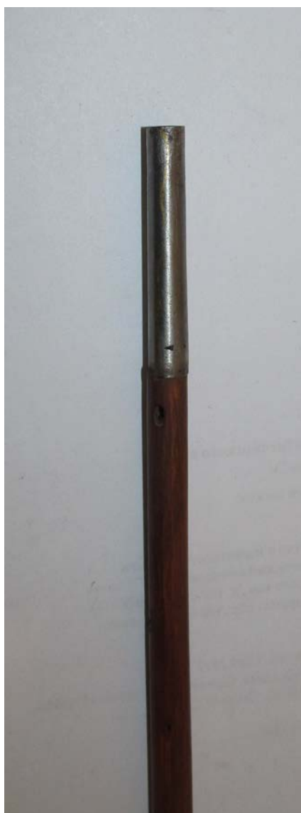
Нижний конец шомпола кремневого штуцера с трубкой для крепления вишера
