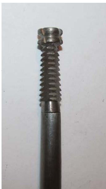
Вишер, присоединенный к нижнему концу шомпола
