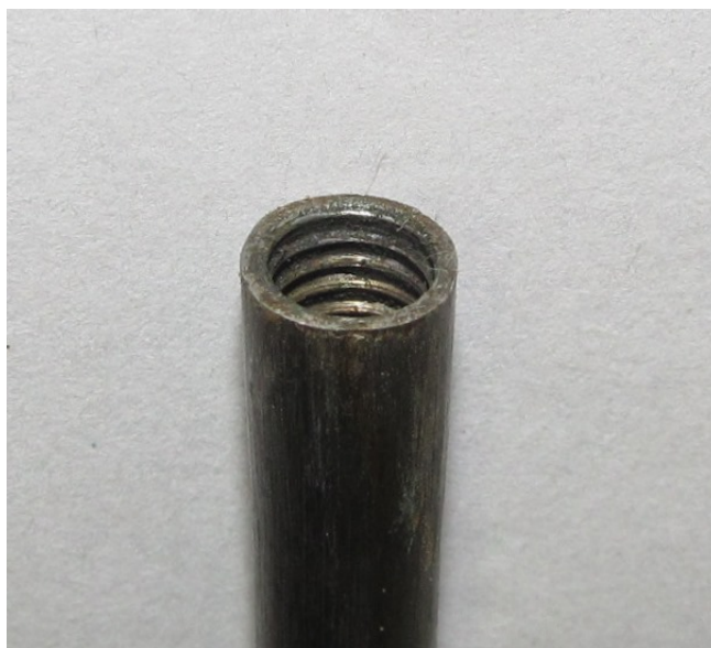
Резбовое отверстие в нижнем конце шомпола для крепления вишера
