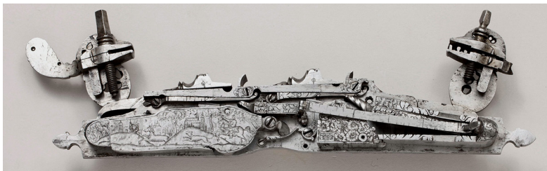
Ил. 7. Внутренняя сторона колесного замка штуцера инв. № ГДМ-364-IX
