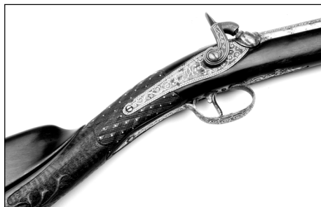
Капсюльный замок охотничьего ружья работы А. Вольферца
