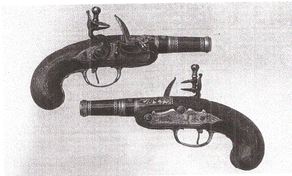
Ett par flintlåspistoler, signerade LES RUNDBERG SUEDOIS. Total längd 17 cm. Pipornas längd 8,5 cm, slätborrade. Beslag av järn med inläggningar av guld. Kaliber 10 mm. (Livrustkammaren)
