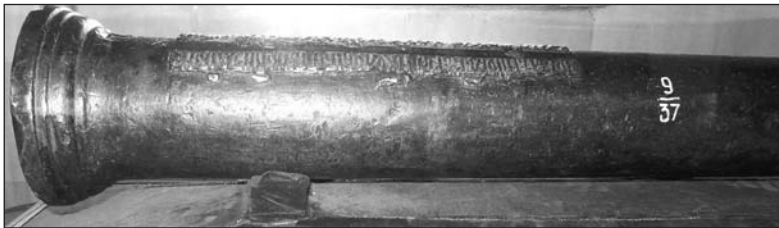
Рис. 14. 2-гривенковая пищаль. «Пушечные избы» Московского Кремля. 1491 г. Мастер – Яков. ВИМАИВиВС. Инв. № 9/37. Калибр 66 мм. Длина пищали – 137,6 см, вес – 76,12 кг
