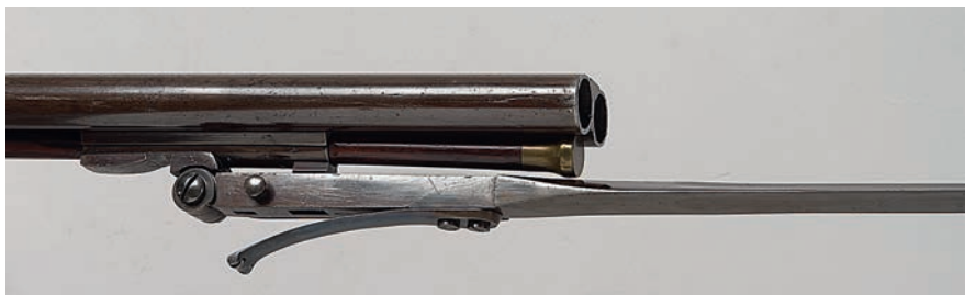
Ил. 5. Подпружиненный механизм штыка
