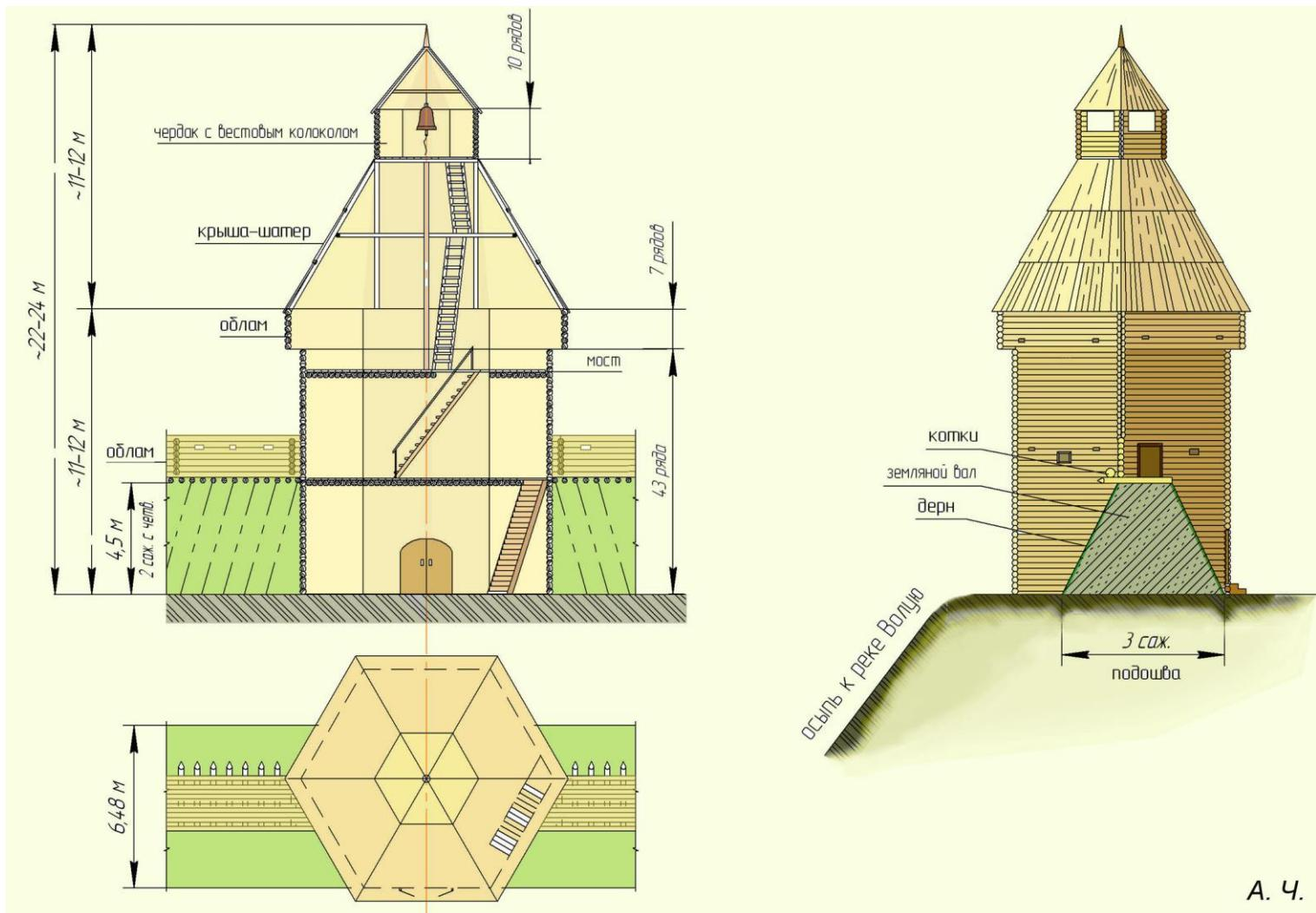
Рис. 16. Вестовая башня Волуйки 1647 г. Графическая реконструкция автора
