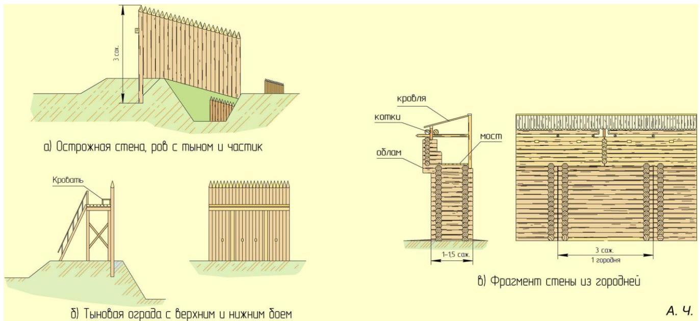
Рис. 6. Варианты деревянных оград крепости. Графическая реконструкция автора
