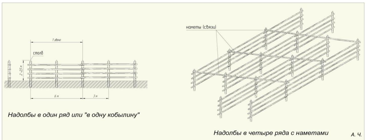
Рис. 14. Надолбы. Графическая реконструкция автора
