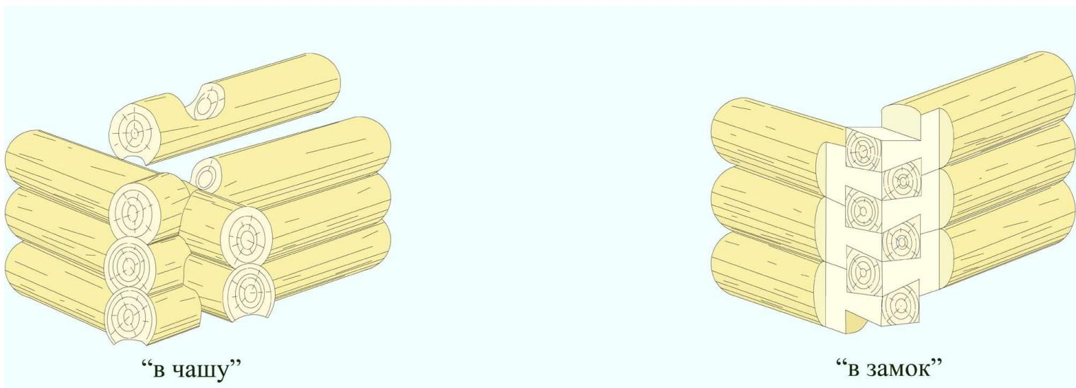
Рис. 18. Приёмы рубки брёвен. Графическая реконструкция автора
