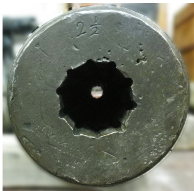
Ил. 3. Дульный срез и нарезы (ВИМАИВиВС МЧА 9/59)
