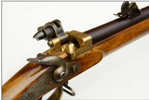
Затвор русской пехотной винтовки сист. С. Крка обр. 1869 г.
